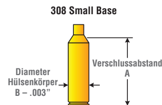
.308 Small Base behält den gleichen Verschlussabstand A wie die .308 Win, reduziert jedoch den Durchmesser B um 0,003" gegenüber der .308 Win, was manchmal für die Zuführung und Funktion der Munition erforderlich ist, die für die Verwendung in halbautomatischen, Repetier-, Pump- und einigen Unterhebelgewehren vorgesehen ist. (Order No. Sizer 30853)
